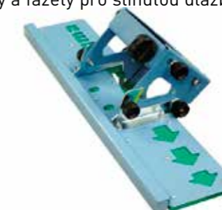
Obr. 5 Přenosná rezačka a bruska na jolly hrany, fabionu a fazety pro slinutou dlažbu
